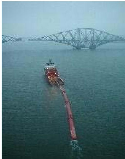
Figura 37. Prototipo de un generador de ondas Pelamis. (Fuente: “Renovable Energy – Power for a Sustainable Future”, Godfrey Boyle, 2ª Edn.)
